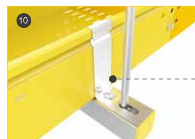
侧面固定夹：将OFT固定在吊装支架上。固定夹底部用螺栓固定在支架上，上部利用金属的弹力将OFT部件固定住，需要拆卸时，只需要将固定夹拨开即可，无需拆卸螺丝。
